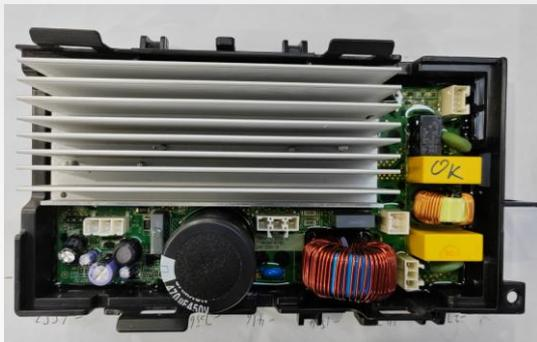
图1 双电机+PFC量产实物
