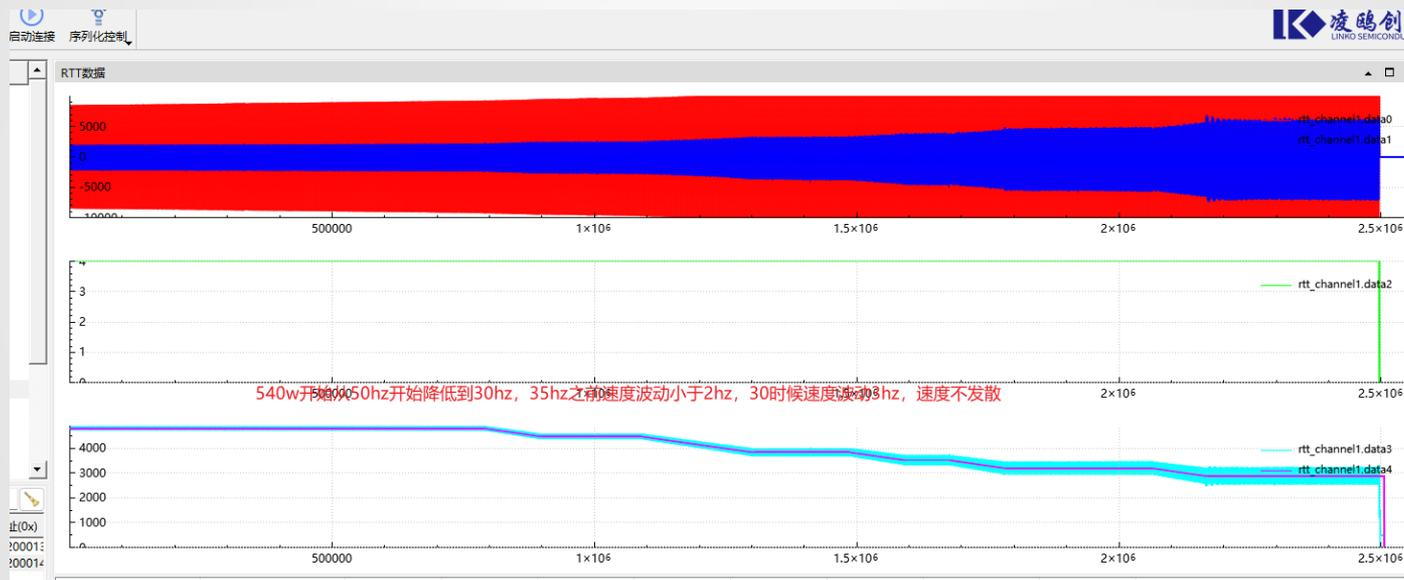
自适应调参时，从图中可知，随着逐渐向最优补偿角靠近，转速波动在减小
