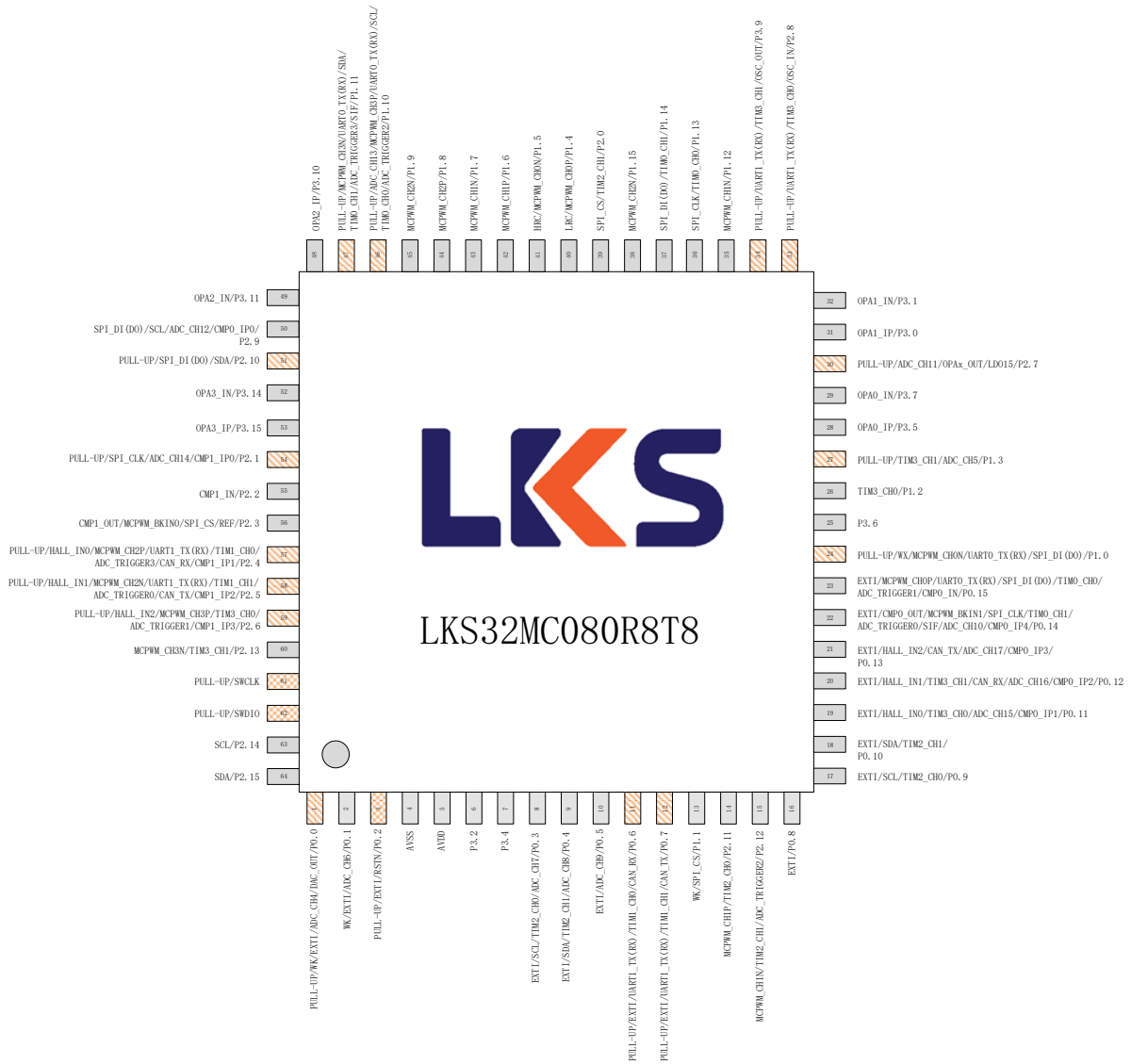
图 3-1 LKS32MC080R8T8(B)管脚分布图
