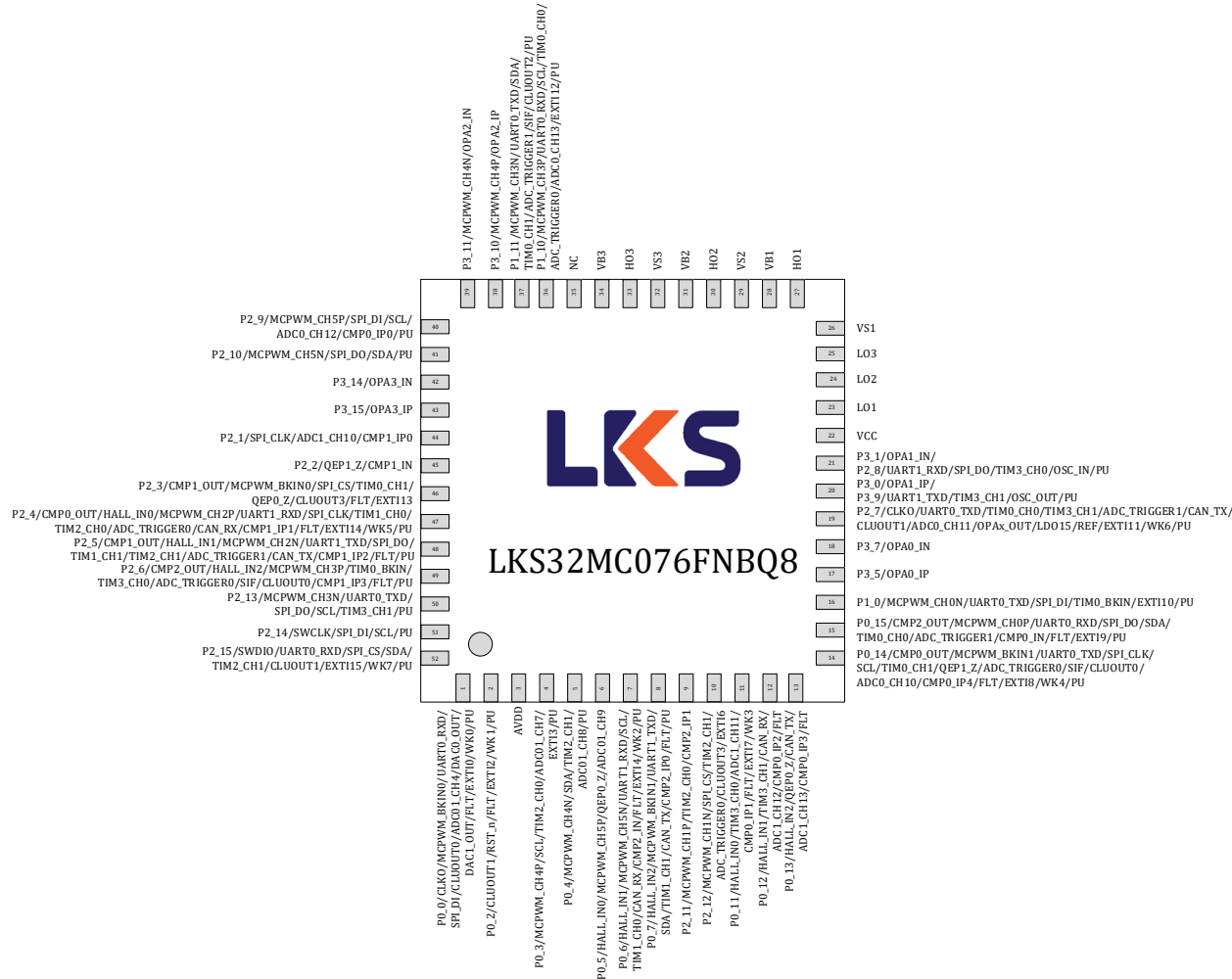
图 3-11 LKS32MC076FNBQ8 管脚分布图
