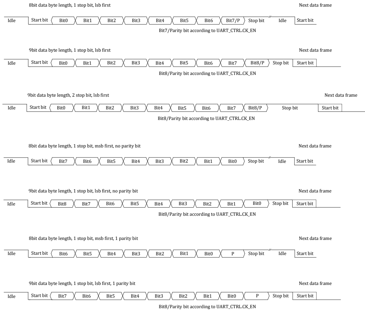
Figure17-1 Uart frame format
