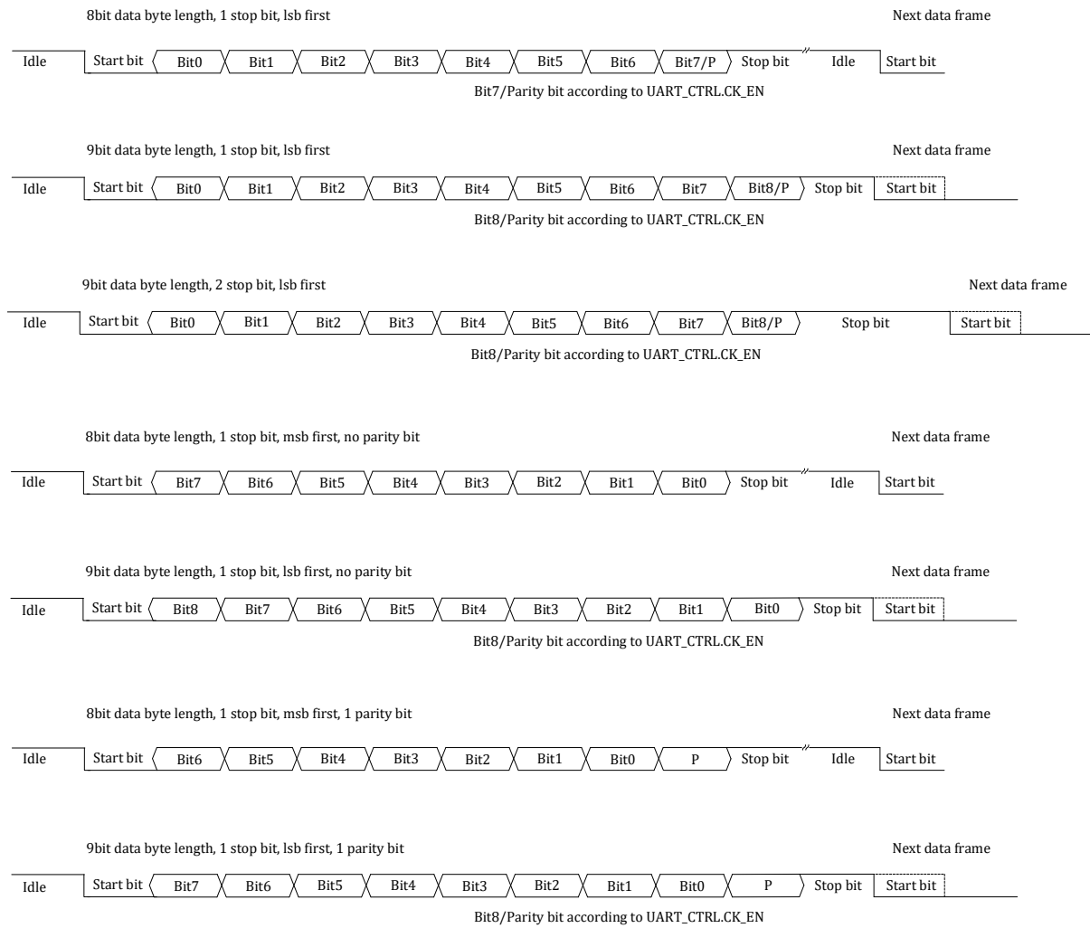
Figure17-1 Uart frame format
