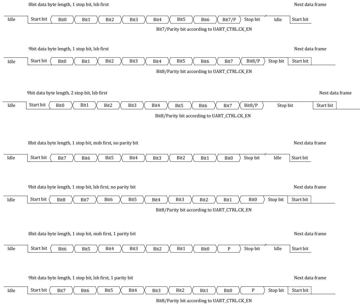
Figure17-1 Uart frame format
