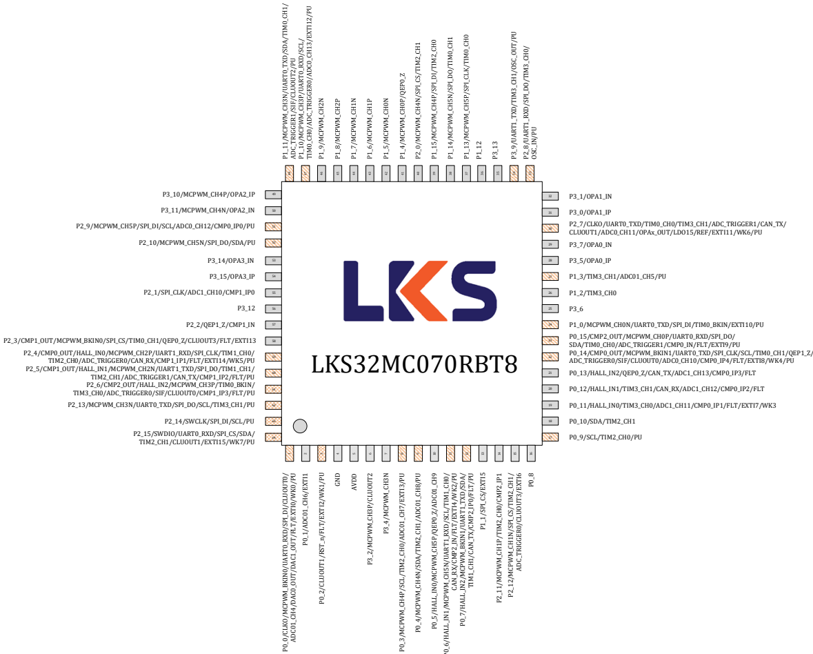
图 3-1 LKS32MC070RBT8 管脚分布图
