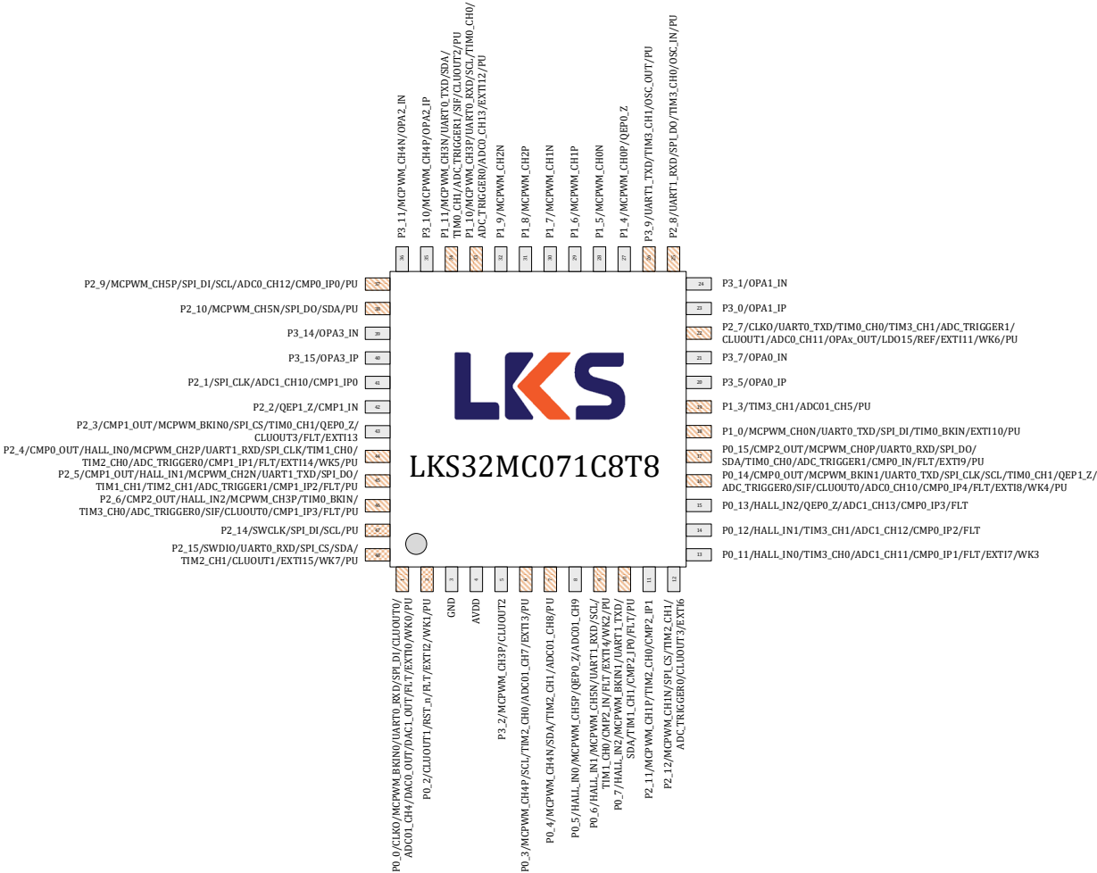
图 3-2 LKS32MC071C8T8 管脚分布图
