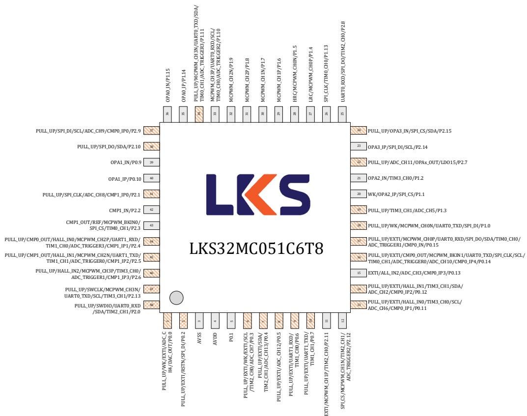
图 3-1 LKS32MC051C6T8 管脚分布图
