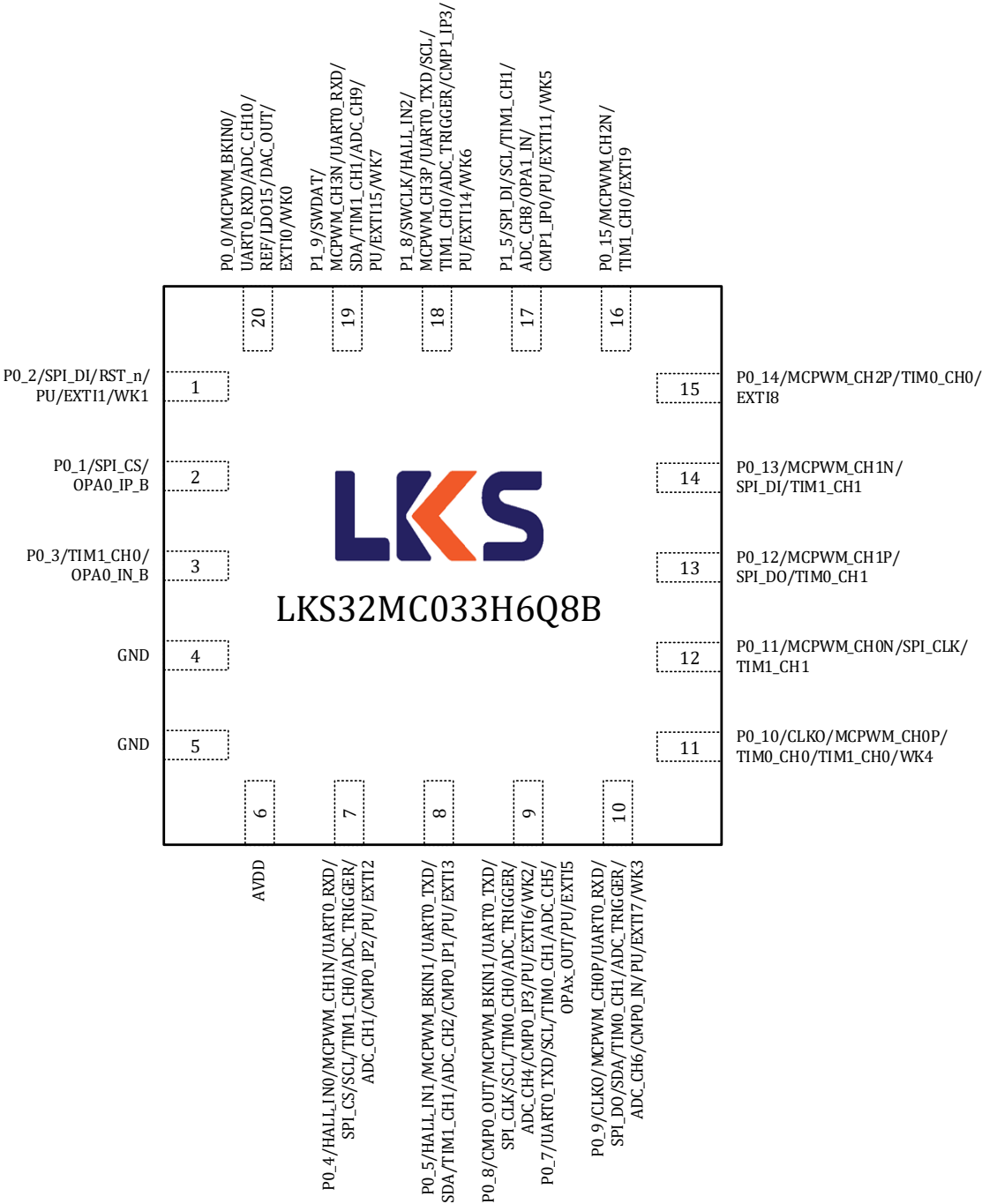
图 3-5 LKS32MC033H6Q8B 管脚分布图
