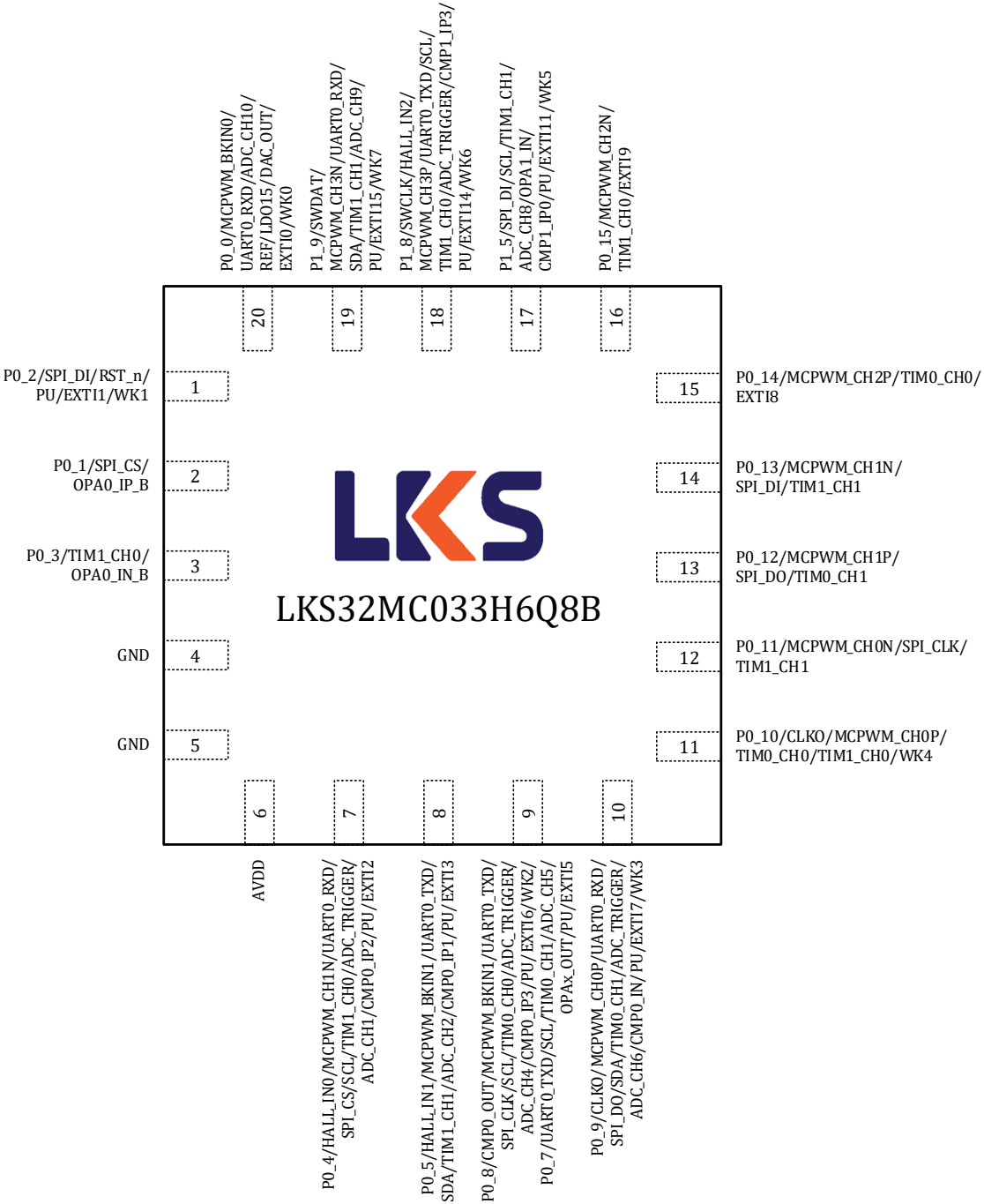
图 3-5 LKS32MC033H6Q8B 管脚分布图
