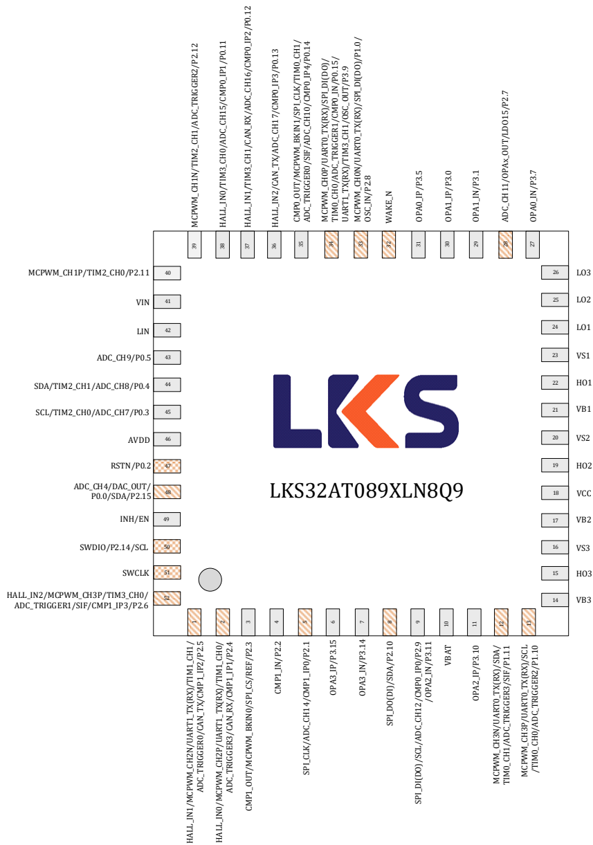
图 3-1 LKS32AT089XLN8Q9 管脚分布图
