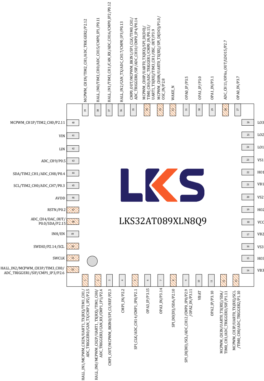
图 3-1 LKS32AT089XLN8Q9 管脚分布图
