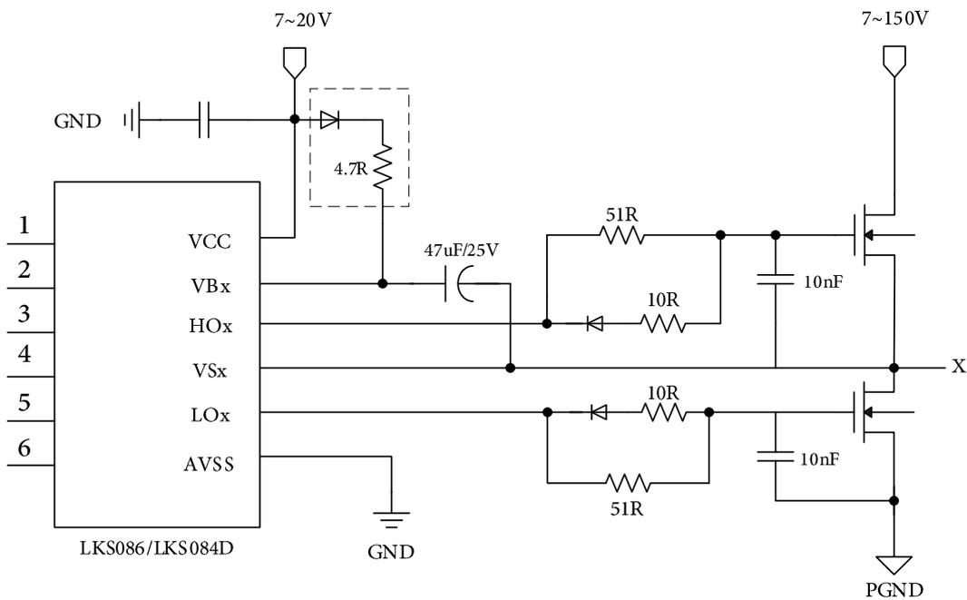
图 22-1 LKS32AT086N8Q9(B)驱动模块典型应用图
