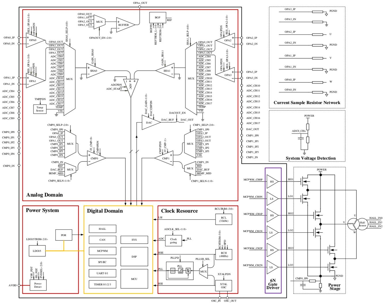
图 1-3 LKS32AT086N8Q9(B)矢量正弦控制系统简化原理图
