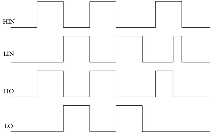
图 22-2 LKS32AT086N8Q9(B)(YYWWXC)栅极驱动极性示意图
