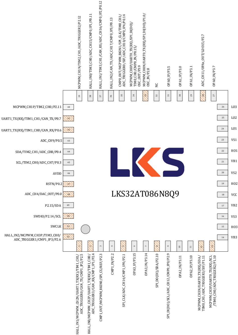
图 3-1 LKS32AT086N8Q9(B)管脚分布图
