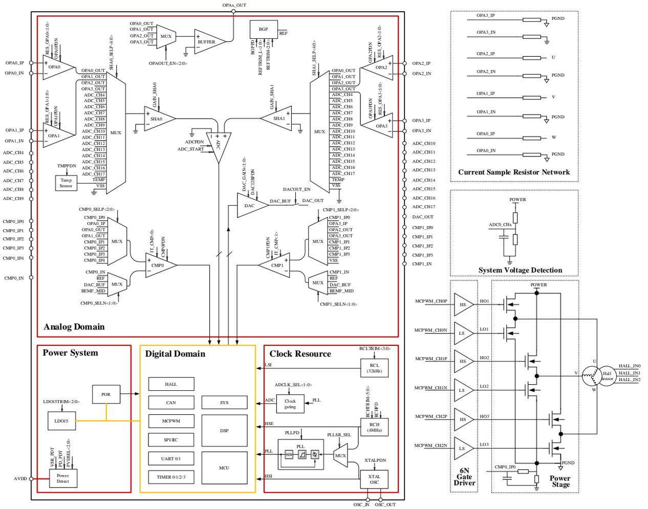
图 1-3 LKS32AT085 矢量正弦控制系统简化原理图
