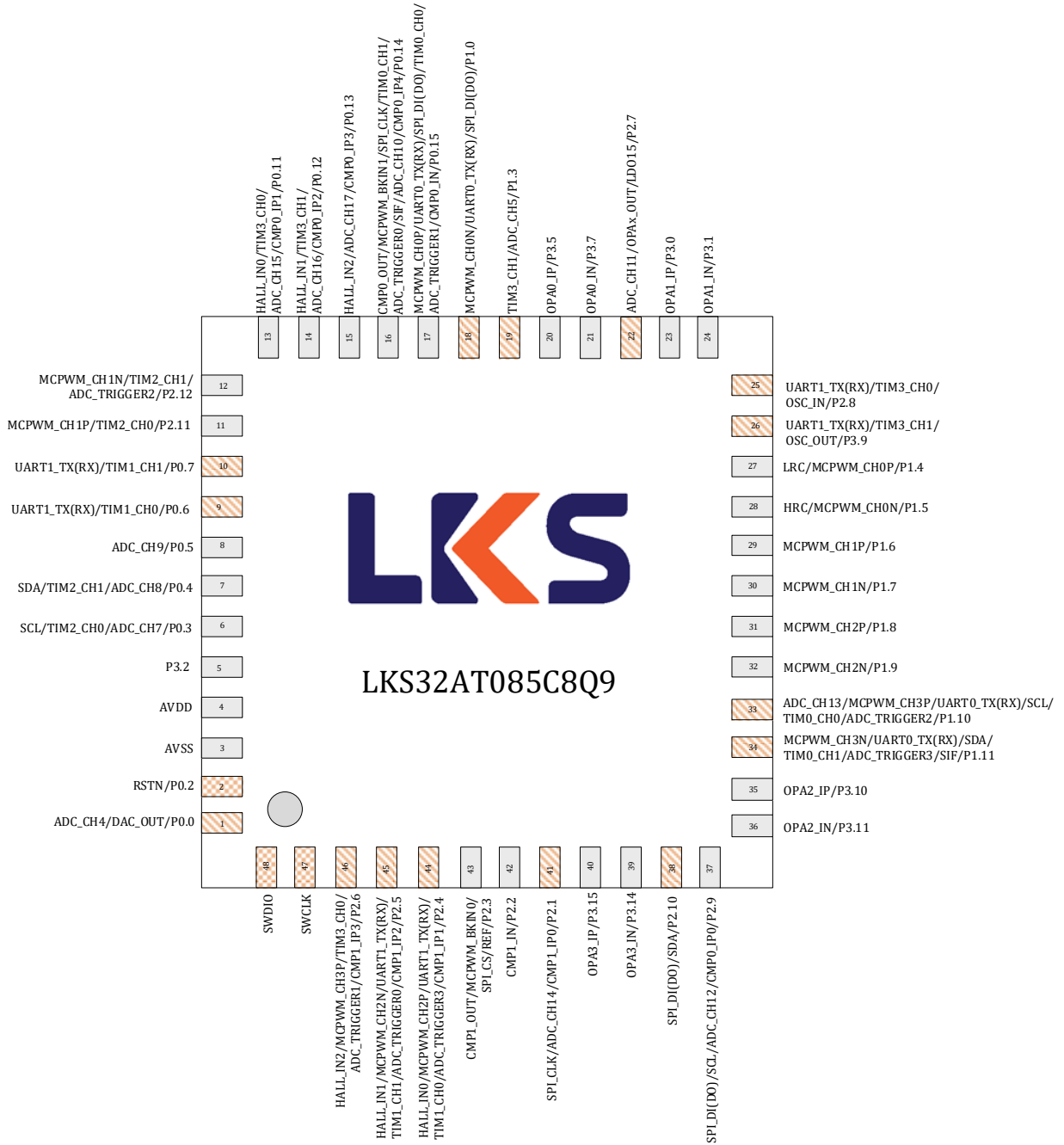
图 2-1 LKS32AT085C8Q9(B)管脚分布图
