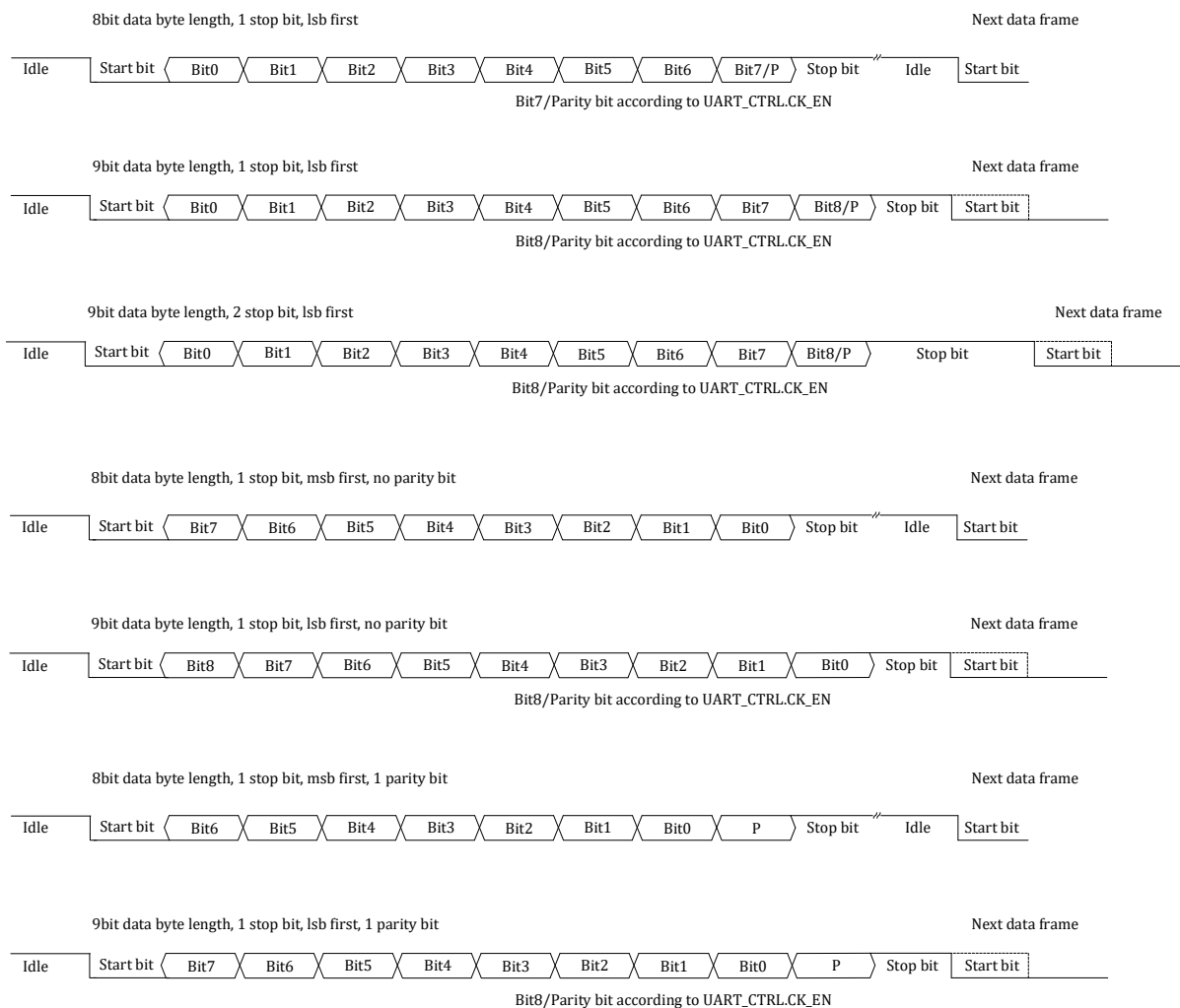
Figure17-1 Uart frame format
